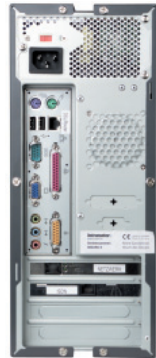
▲ Sehr gut: Beim Intranator sind die Netzwerk-, DSL- und ISDN-Anschlüsse gut sichtbar beschriftet .
