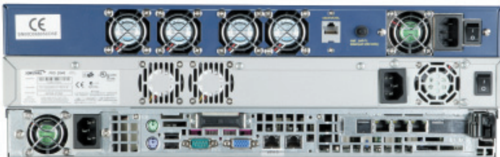
Besser in den Serverraum: Die vielen Lüfter sorgen bei den 1HE-Geräten für eine laute Geräuschkulisse
